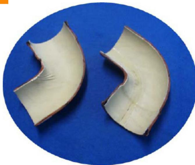
**Importante.** los parámetros para las presiones de inversión indicados son valores de laboratorio, con variables dependiendo de la sección de la manga, de su espesor y del estado del fieltro en el momento de su utilización. Recomendamos hacer pruebas propias bajo las condiciones reales de obra antes de rehabilitar. los extremos de la manga no recubiertos por el colector a rehabilitar deben ser protegidos/encofrados. se debe hacer pruebas con el tipo de resina elegido antes de su instalación
